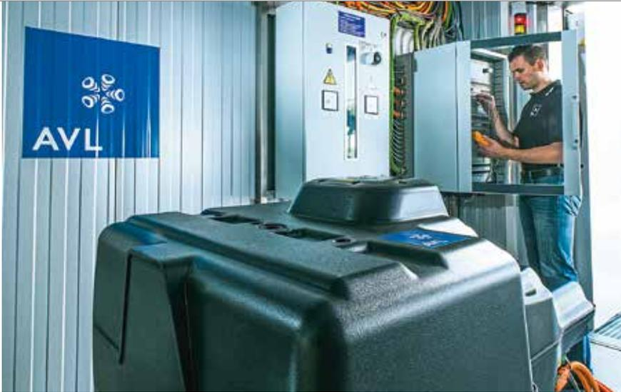
**Antriebsbatterie in einem Prüfstand.**
