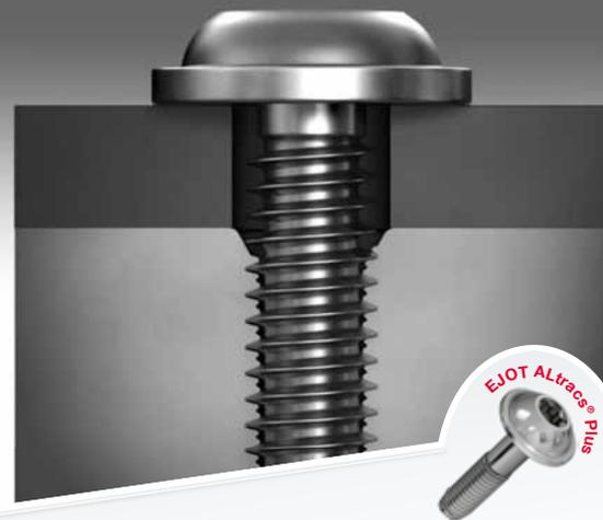
Die ALtracs® Plus Schraube ist ein spezielles Verbindungselement für die Direktverschraubung in Leichtmetalle. Die Verschraubung erfolgt direkt im gegossenen Loch. Dadurch sind durch das Einsparen der bisher üblichen Arbeitsschritte signifikante Kosteneinsparungen möglich. Die ALtracs® Plus furcht beim Einschrauben ein geometrisch gestärktes, metrisch kompatibles Muttergewinde.
