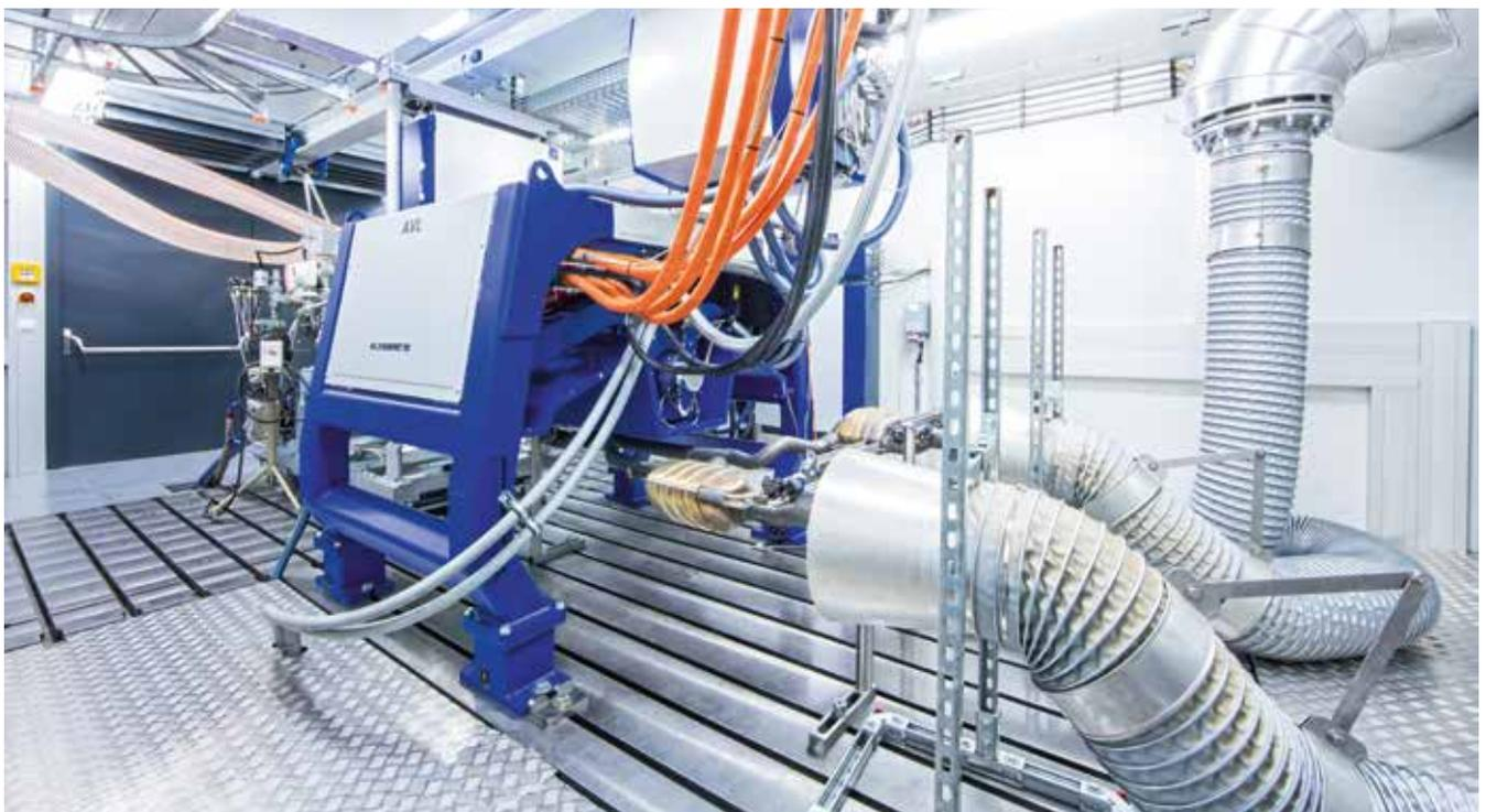
Mit der permanentmagneterregten Synchronmaschine „DynoUltra“ von AVL lassen sich diverse Betriebszustände des Verbrennungsmotors am Prüfstand realisieren.
