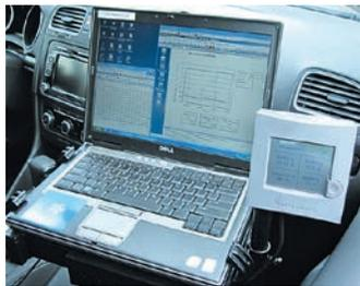
AVL M.O.V.E GAS PEMS – portables Messgerät für Emissionsmessungen
