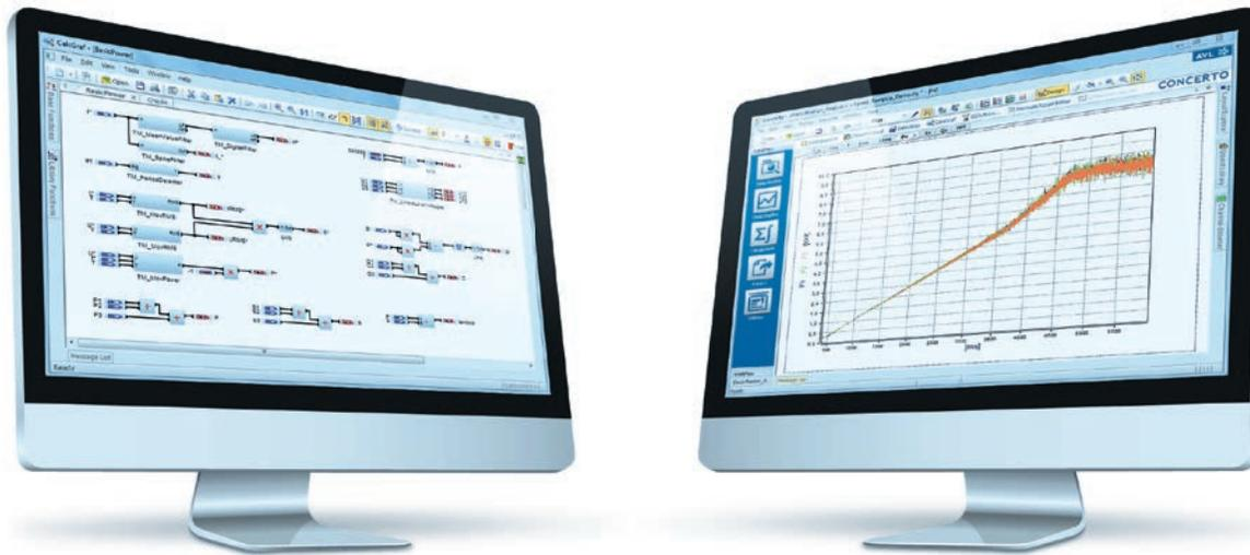
Standard-Berechnungen sind als grafische Berechnungsmodelle vordefiniert: z. B. automat. Ermittlung der elektrischen Periode, Berechnung der Phasenspannung aus der verketteten Außenleiter-Spannung (dies macht die Verwendung von externen Sternpunkt-Adapttern obsolet). Zusätzlich sind Berechnungsregeln beliebig um anwenderspezifische erweiterbar.
