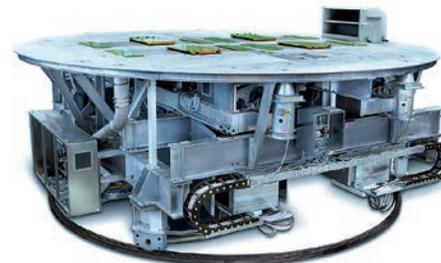
AVL ROADSIM EMC 4x4 CAR Fahrzeugprüfstand für elektromagnetische Verträglichkeitsuntersuchungen
