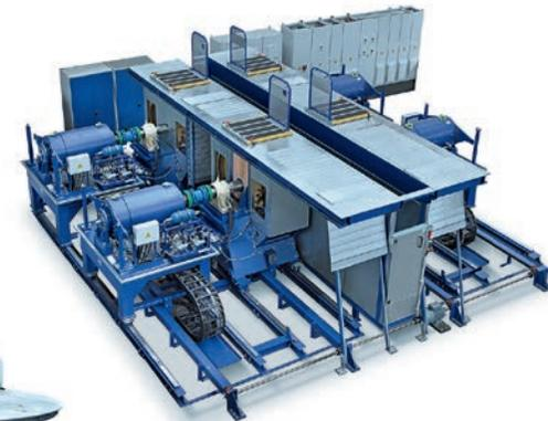
AVL ROADSIM NVH 4x4 LIGHT TRUCK Fahrzeugprüfstand für Geräusch- und Vibrationsuntersuchungen
