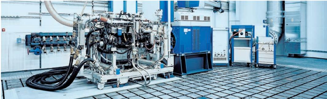
Prüfstands Aufbau zur Motorkalibrierung
