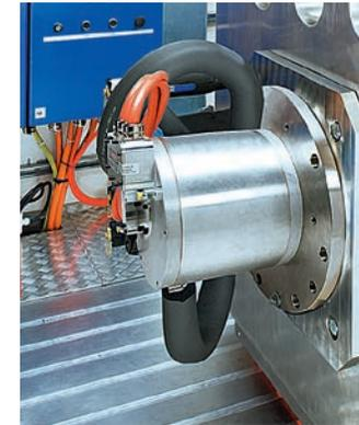
AVL E-Motor-Prüfstand, Klimakammermodul aufgeschoben
