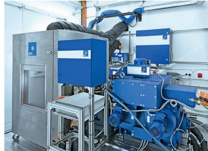
AVL E-Motor-Prüfstand mit Klimakammermodul
