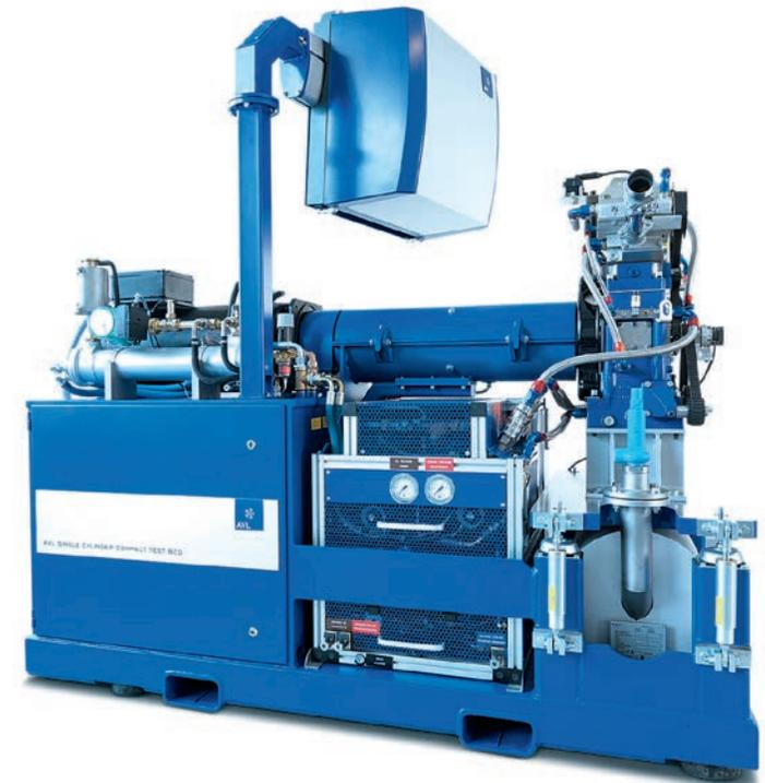
Prüfstandsordnung zur Verbrennungsentwicklung am Einzylinder-Prüfstand
