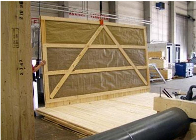
Abbildung 7: Seitenwand mit Sperrschicht ausgekleidet
