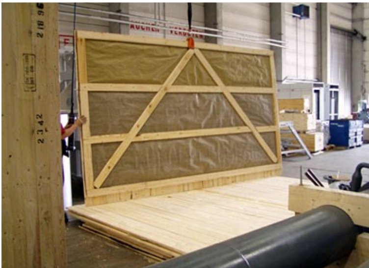
Abbildung 7: Seitenwand mit Sperrschicht ausgekleidet
