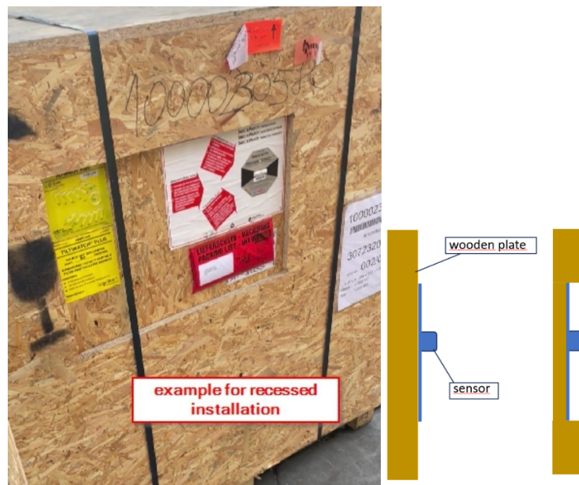
Abbildung 13: Vorgabe für die Montage der Indikatoren
